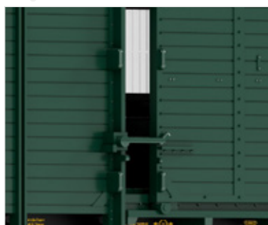
Türen an den Seitenwänden verschiebbar und Verriegelungshebel beweglich ausgeführt
