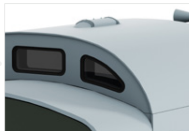
Dachkanzel mit bündig eingesetzten Fenstern
