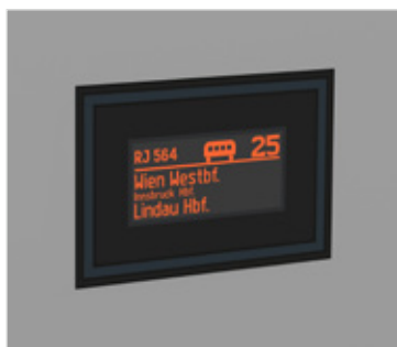
Zugzielanzeigen in der Digitalausführung beleuchtet
