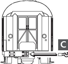
(DE) Drehgestell mit Lichtmaschine
