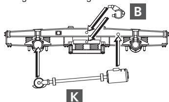
(DE) Drehgestell ohne Lichtmaschine mit Achslagerdeckel
