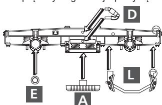
(DE) Drehgestell mit Achsgenerator und Dämpfer für Geschwindigkeiten > 140 km/h
