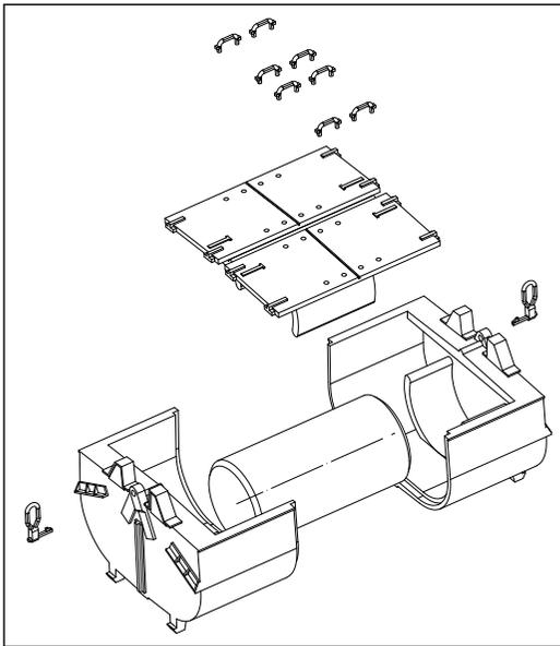
Es wird empfohlen, die Bohrungen für die Griffstangen des Kübeldeckels mit einem Bohrer Durchmesser 0,5 aufzubohren, damit die Führung der Griffstangen vergrößert wird. Zu diesem Zweck kann der Deckel abgenommen werden. Er ist auf dem Kübel aufgerastet.
