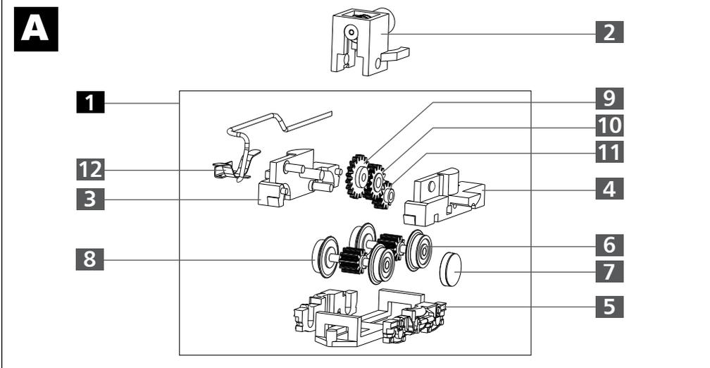
**DREHGESTELL • BOGIE • OTOČNÝ PODVOZEK**
