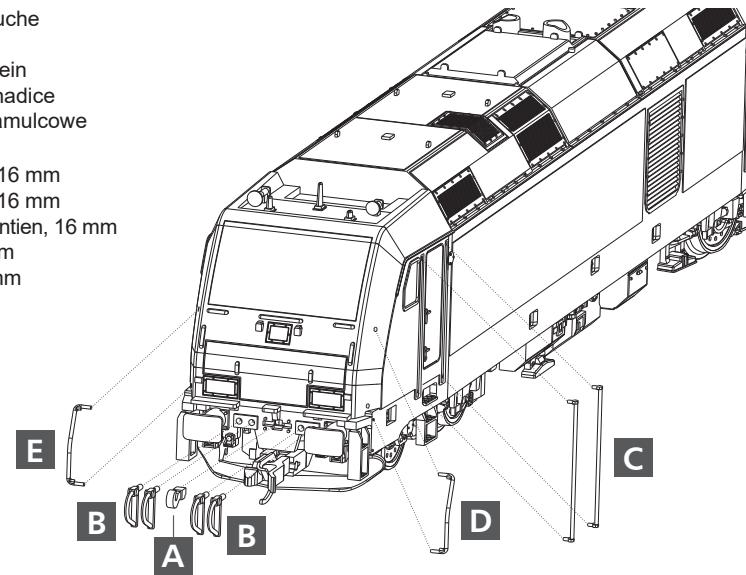
**(DE)** Beim Betriebseinsatz ist zu beachten, dass die Bremsschläuche die Funktion der Kupplungsdeichsel behindern.
