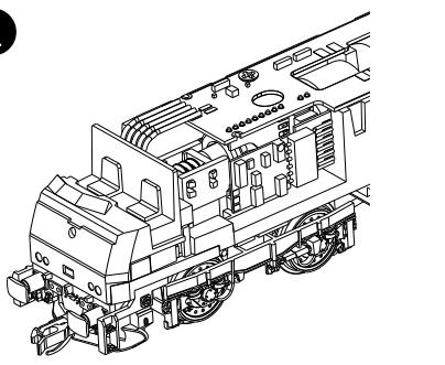
(DE) Für eine Digitalisierung gibt es im Modell eine PluX12 Schnittstelle. Wir empfehlen die Verwendung eines Decoders PluX12 von Uhlenbrock (TILLIG Art.-Nr. 66034).
