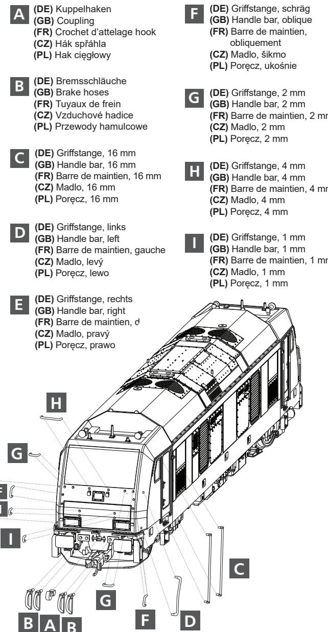
(DE) Beim Betriebeinsatz ist zu beachten, dass die Bremsschlüche die Funktion der Kupplungsdeichsel behindern.
