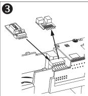
(DE) Zum Einbau eines Decoders nach NEM 651 S klein wird nur der Entstörsatz abgezogen. Danach kann ein Decoder nach NEM 651 S klein eingesteckt werden. Hierfür empfehlen wir den Decoder von Uhlenbrock (TILLIG Art.-Nr. 66032).
