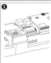
(**DE**) Für eine Digitalisierung gibt es im Modell eine PluX12-Schnittstelle. Wir empfehlen die Verwendung eines Decoders PluX12 von Uhlenbrock (TILLIG Art.-Nr. 66035). Zum Einbau des Decoders ist das Oberteil entsprechend der Anleitung auf Seite 1 abzunehmen. Quer in der Rahmenaussparung befindet sich die Decoderschnittstelle.
