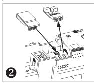
(**DE**) Zum Einbau eines PluX12-Decoders nach NEM 658 wird der Entstörsatz mit dem Adapterleiterplatte abgezogen. Danach kann ein PluX12-Decoder eingesteckt werden.
