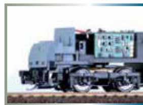
Decoder eingebaut / Installed decoder
