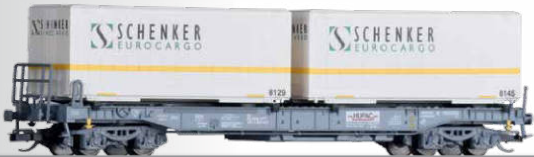
Taschenwagen Sdkmss HUPAC der SBB, beladen mit zwei Wechselbehältern Pocket wagon Sdkmss HUPAC of the SBB with two swap bodies
