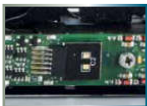
Entstörersatz eingebaut / Installed interference suppression set
