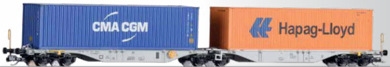
Containertragwagen Sggmrss 578.0 der ÖBB, beladen mit zwei 40'-Containern Containertragwagen Sggmrss 578.0 of the ÖBB with load
