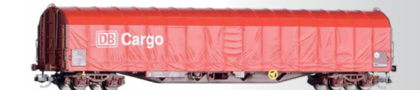
Schiebeplanenwagen Rils 652 der DB Cargo Sliding tarpaulin car Rils 652 of the DB Cargo
