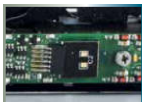
Entstörersatz eingebaut / Installed interference suppression set
