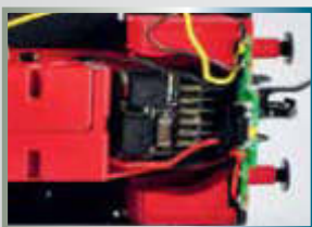
Entstörsatz eingebaut / Installed interference suppression set
