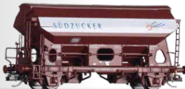
Schwenkdachwagen Tds 930 „Südzucker“ der DB Swing roof car Tds 930 "Südzucker" of the DB
