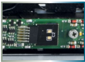
Entstörersatz eingebaut / Installed interference suppression set
