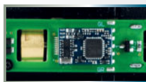
Decoder eingebaut / Installed decoder
