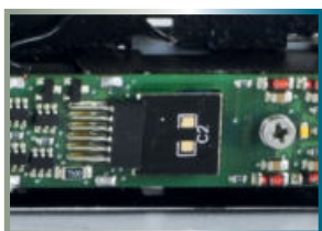
Entstörersatz eingebaut / Installed interference suppression set
