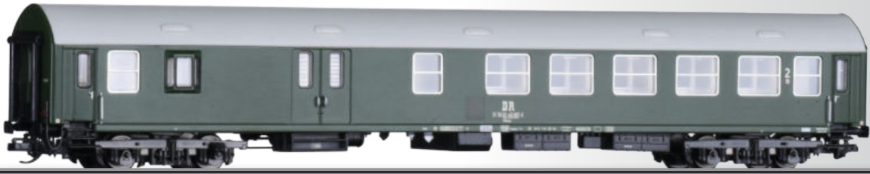
Reisezugwagen 2. Klasse mit Gepäckabteil BDMse der DR 2nd class passenger coach with baggage compartment BDMse of the DR
