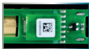
Entstörersatz eingebaut / Installed interference sup- pression set
