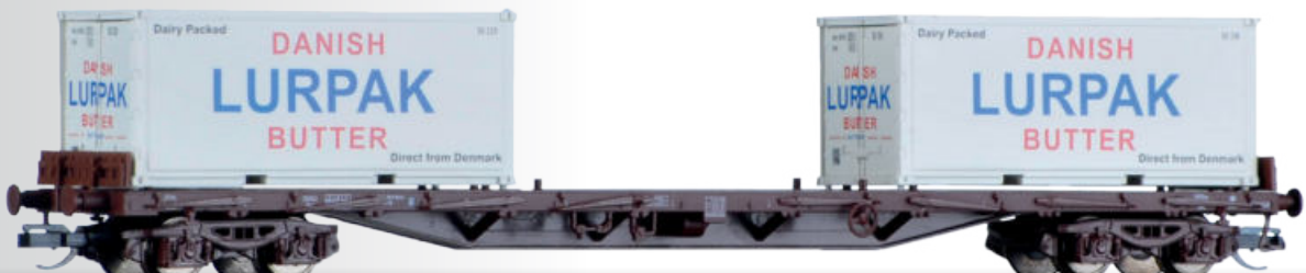
Containertragwagen Rs der DSB, beladen mit zwei 20' Containern Container car Rs of the DSB with two 20' container
