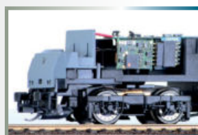
6-poliger Decoder eingebaut / Decoder 6 pole installed
