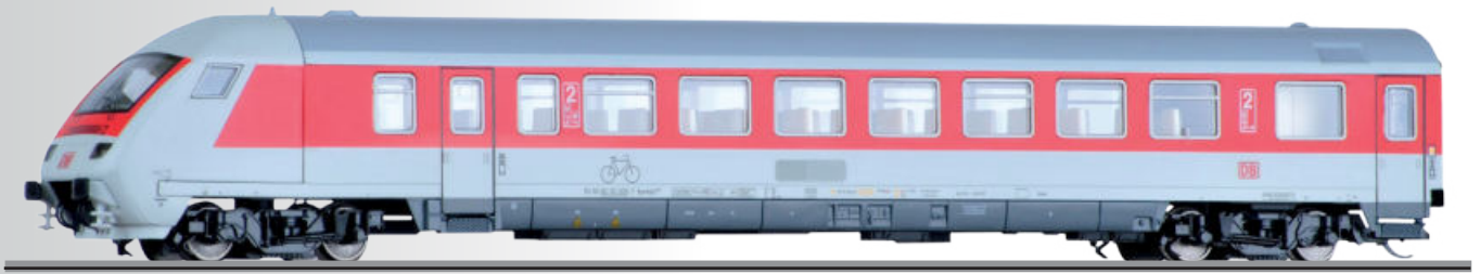
Steuerwagen Bpmbdzf 297 der DB AG Driving cab coach Bpmbdzf 297 of the DB AG
