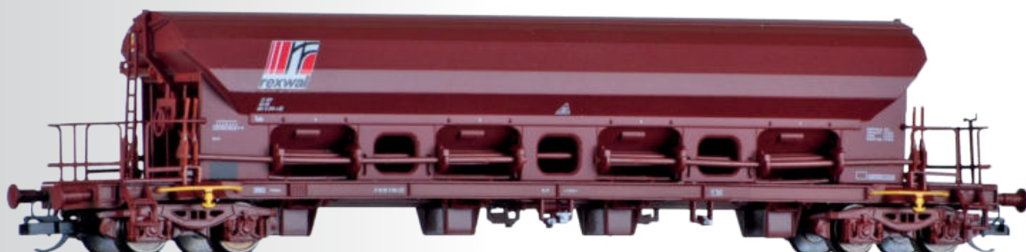
Schwenkdachwagen Tads „Rexwal“, eingestellt bei der DB AG Swing roof car Tads “Rexwal” of the DB AG
