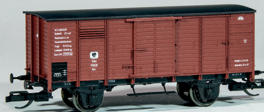
113910 Gedeckter Güterwagen Gm mit Flachdach, KPEV, Epoche I
