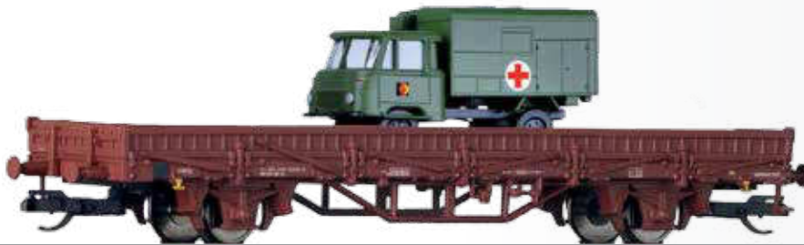
Niederbordwagen Ks der DR, beladen mit LKW Robur LO 1801 NVA Kofferaufbau Low side car Ks of the DR with truck Robur LO 1801 NVA box
