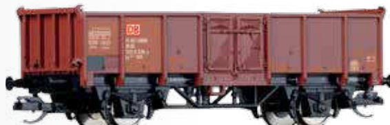
Offener Güterwagen Es 026 der DB AG mit Flicklackierung Open car Es 026 of the DB AG with patches painting
