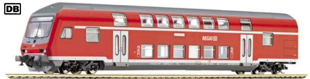
13802 II/2008 Doppelstock-Steuerwagen der DB AG, mit neuem DB-Regio-Logo Double-decker driving cap coach of the DB AG, new logo „DB Regio“
